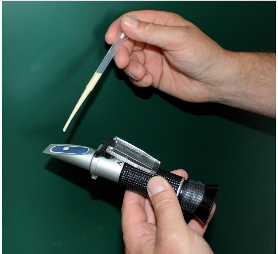
**Mit dem Refraktometer kann und sollte die Qualität der Biestmilch überprüft werden.**
